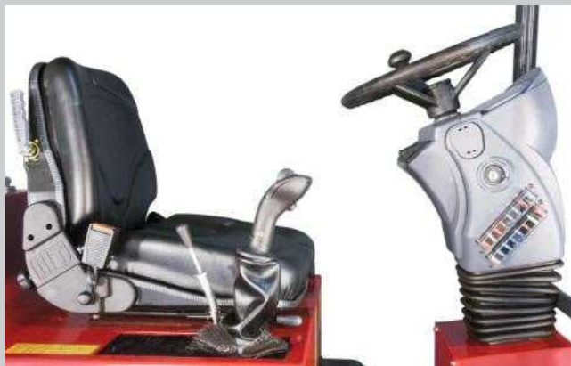
Einhebelbedienung - Verstellbare Lenksäule
