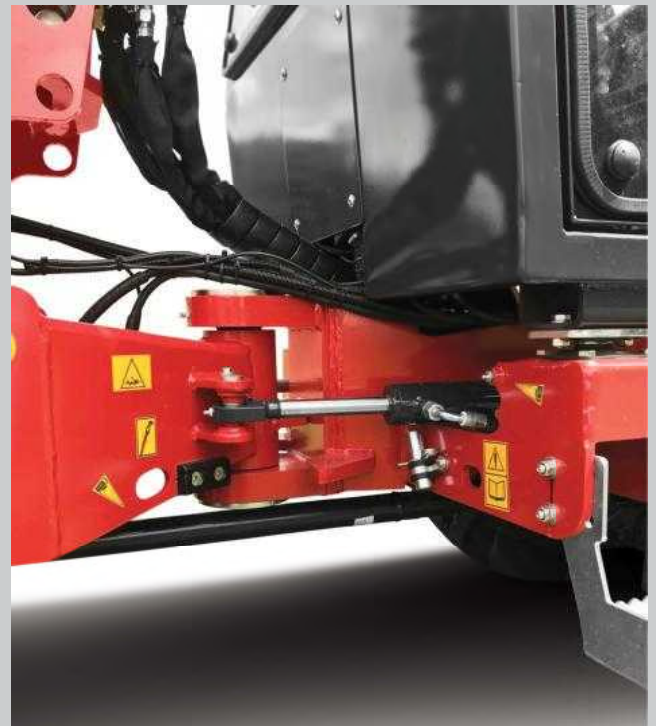
Stabiles Knickgelenk mit 2 Lenkzylindern
