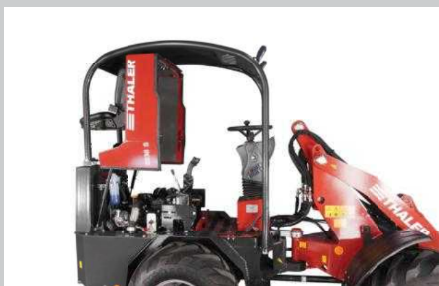
Komplett öffnende Motorhaube für gute Zugänglichkeit zur Wartung
