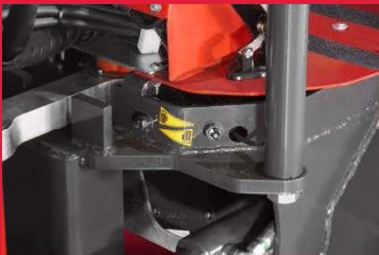
Alle Schmierstellen sind nach außen gelegt
